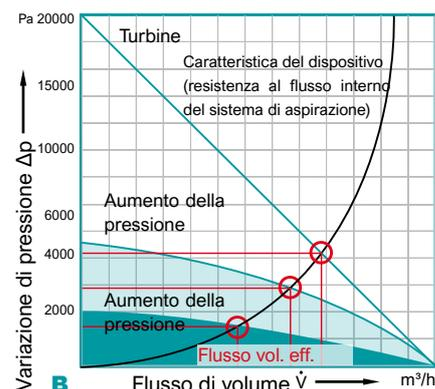
Fig. B: Confronto tra diversi modelli di motore con la stessa portata d'aria a soffio libero.
