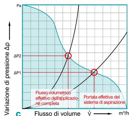
Fig. C: Determinazione del punto di funzionamento combinando gli aumenti di pressione e le perdite.
