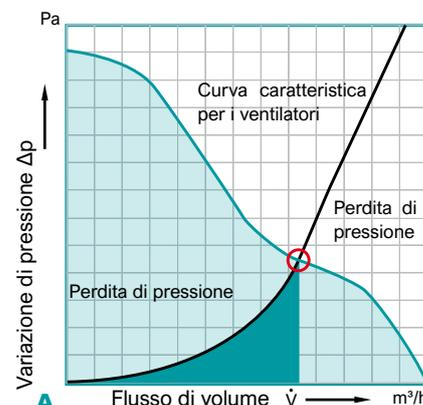
Fig. A: Curva caratteristica dei ventilatori
